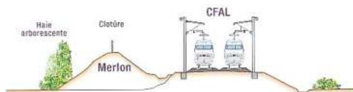
Profil en travers avec protections par merlon (butte de terre)
